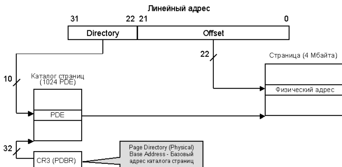
Рисунок 1.12 – Страничная переадресация в режиме PSE (страницы по 4 Мбайт)
